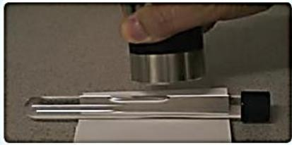
یک لوله آزمایش را تا تزدیکی لبه آن از الکل طبی (اتانول ۹۶ درجه) پر کنید. در لوله را بیندید و آن را به طور افقی قرار دهید. مطابق شکل، یک آهنربای نئودیمیم را بالای حباب هوای درون لوله بگیرد و به آرامی آهنربا را حرکت دهید. دلیل آنچه را مشاهده می کنید در گروه خود به گفت و گو بگذارید.
