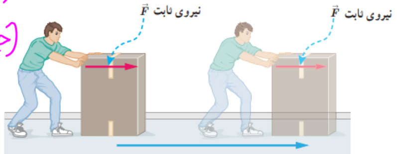
شکل ۳-۳ نیروی ثابت \vec{F} که با جابه‌جایی \vec{d} هم جهت است، کار W = Fd را انجام می‌دهد.
